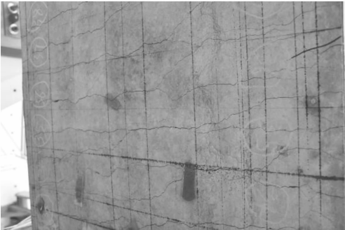
(c) 底板混凝土残余开裂
