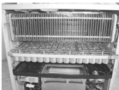
图 4 静电除氡装置内部结构
