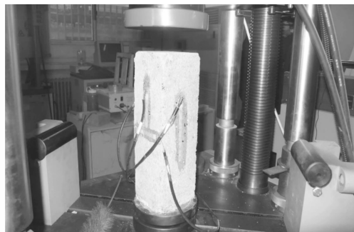
图1 试验加载装置
