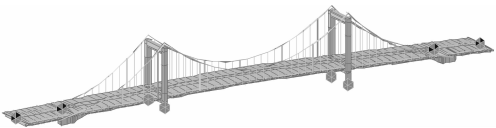
图 3 有限元模型 Fig. 3 Finite Element Model
