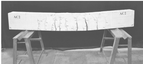
图 5 试件 AC2 最终破坏形态 Fig. 5 Final Failure Mode of Specimen AC2
