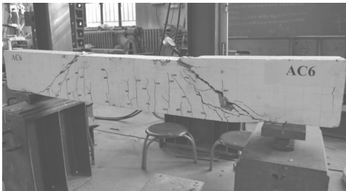
图 7 试件 AC6 最终破坏形态
