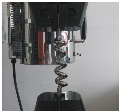
图 2 试验装置中的 SMA 螺旋弹簧
