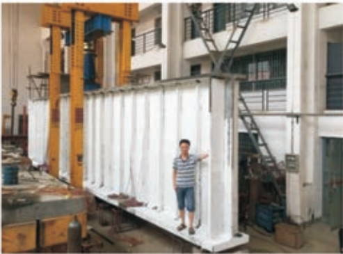
(b) 1:6缩尺UHPC工字梁
