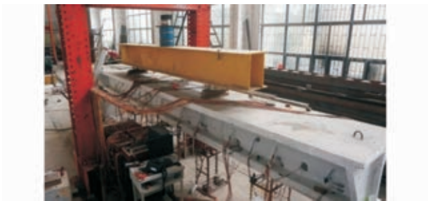
图 40 预制 UHPC “π”形梁整体受弯试验
