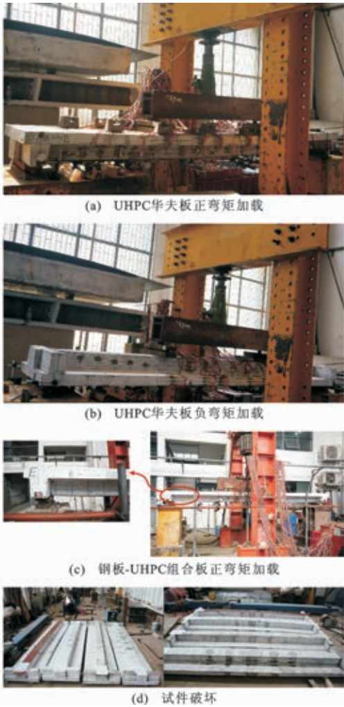
图 28 UHPC 华夫板纵向模型试验
