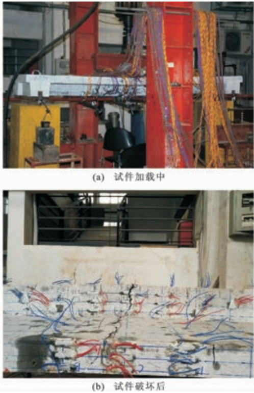
图 29 UHPC 华夫板横向模型试验
