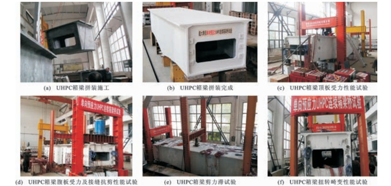
图 33 双悬臂 UHPC 箱梁系列试验
