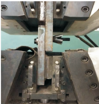
图 14 试件 S-SB16-3-1 破坏情况
