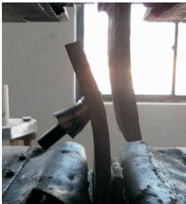
图 12 试件 S-SB16-1-2 破坏情况
