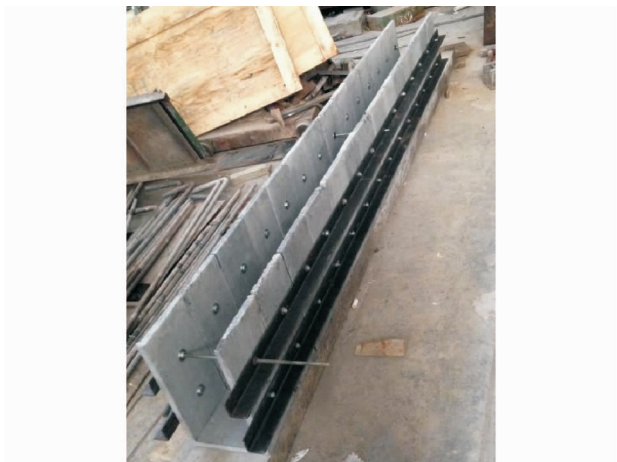
图 4 U 形混凝土模块拼装图
