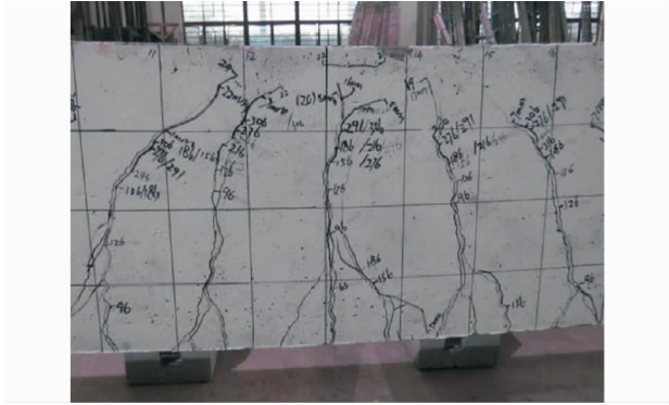
图 12 试件 XJL 裂缝开展照片 Fig. 12 Photograph of Crack Development of Specimen XJL
