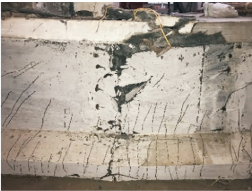
图 8 试验梁破坏模式
