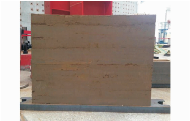
图 2 拆模后的夯土墙试件
