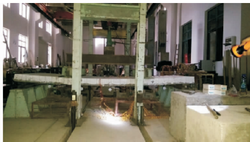
图10 最终破坏照片
