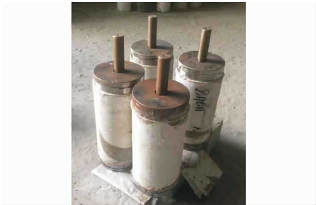
图 1 受拉试件 Fig. 1 Tensile Specimens
