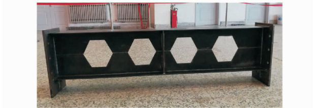
(b) 蜂窝梁试件加工完成图
