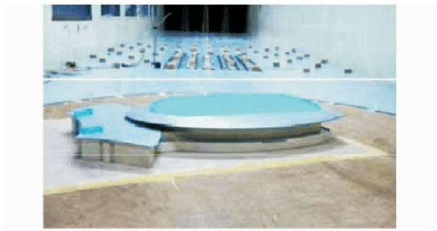
图 4 结构风洞试验模型
