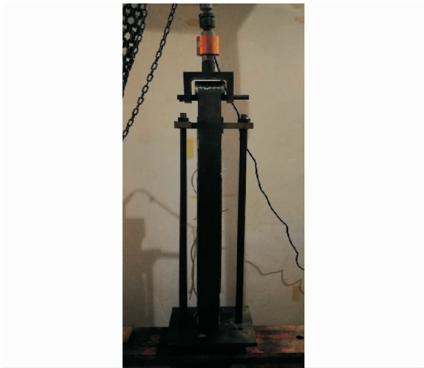
图 2 预应力加载装置
