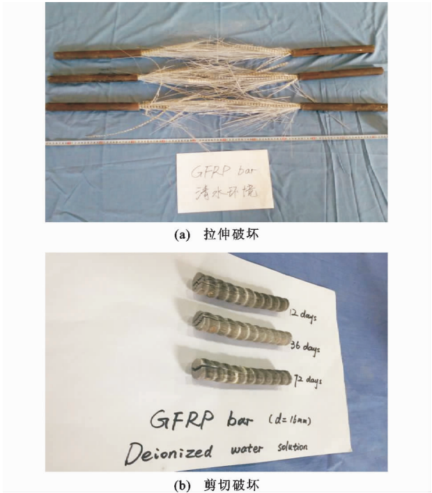
图 2 试样的破坏形式 Fig. 2 Failure Forms of Specimens
