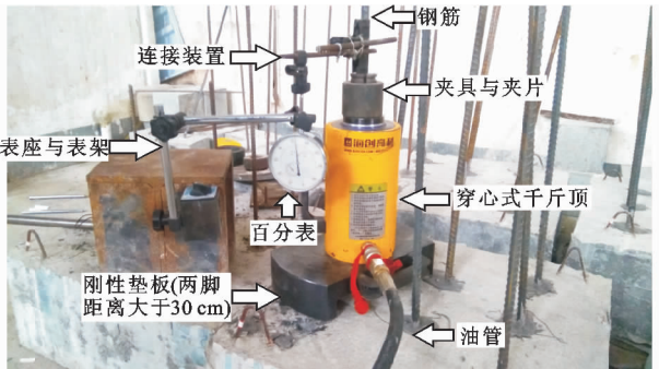
图 3 试验装置照片 Fig. 3 Photo of Test Setup
