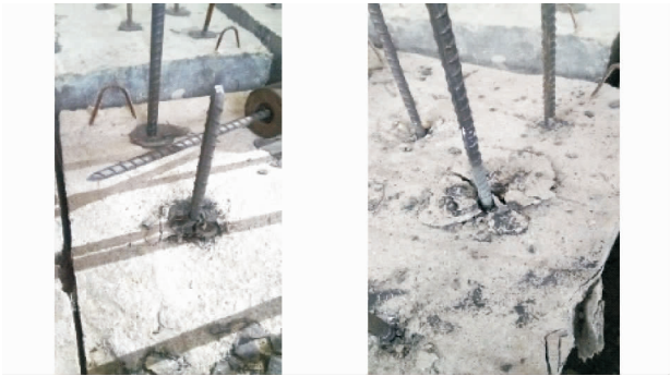
图 5 钢筋拉断破坏 Fig. 5 Tensile Failure of Rebar 图 6 钢筋屈服后拔出 Fig. 6 Pull-out After Rebar Yield
