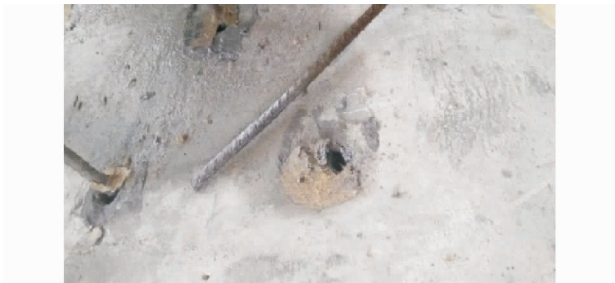
图 7 钢筋未屈服拔出 Fig. 7 Pull-out Before Rebar Yield
