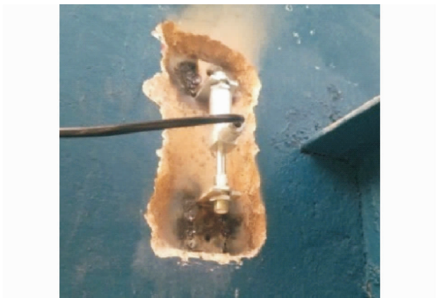
图 7 振弦式应变计在钢柱上的固定
