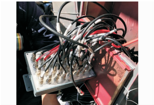
图 6 现场应变采集系统
