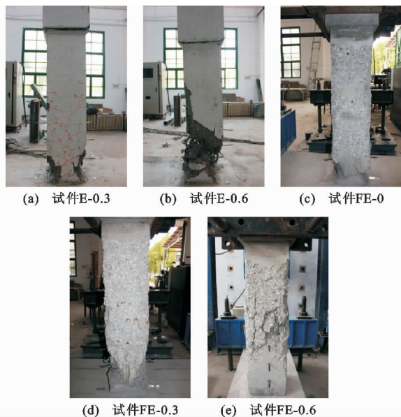
图 7 试件破坏形态
