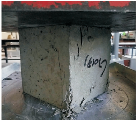
图 2 立方体抗压强度试验加载过程
