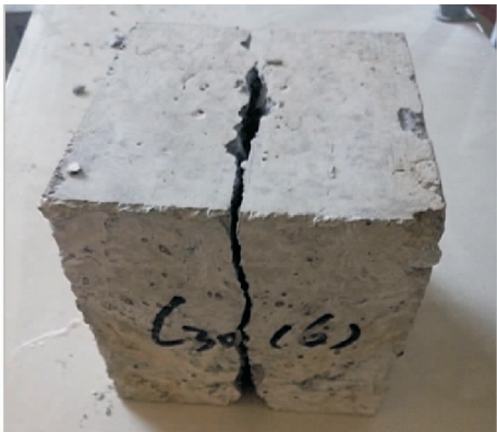
图 7 试件典型破坏形态
