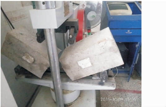
图 14 抗折强度试验加载过程 Fig. 14 Loading Process of Flexural Strength Test
