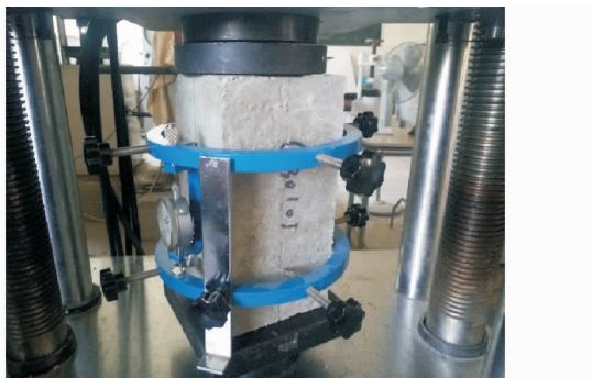
图9 弹性模量试验加载过程
