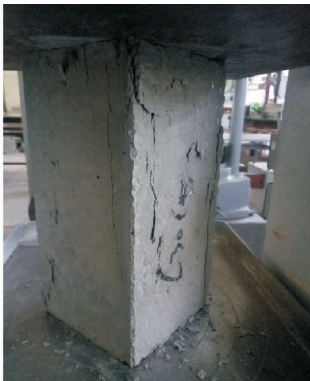
图 4 轴心抗压强度试验加载过程
