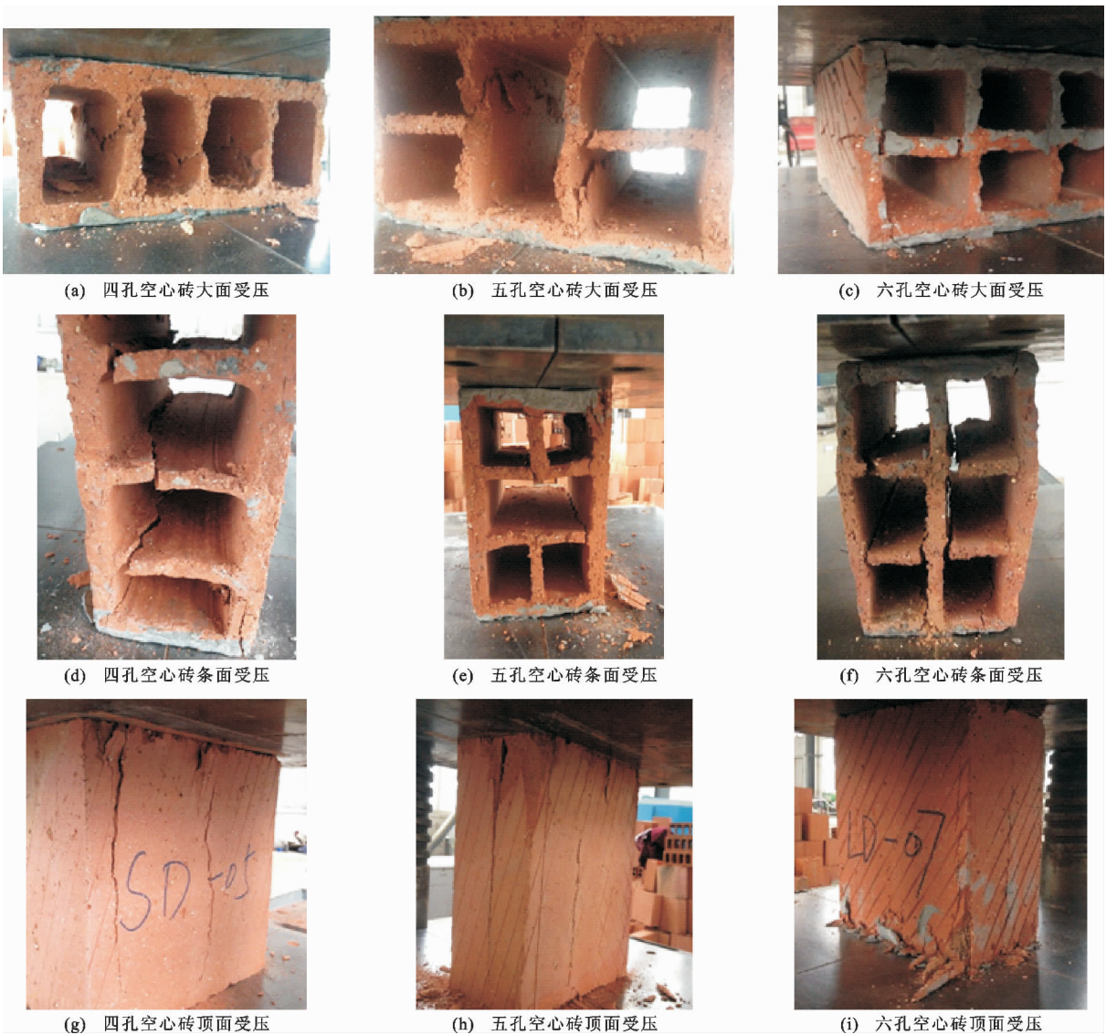
图 2 空心砖受压破坏形态
