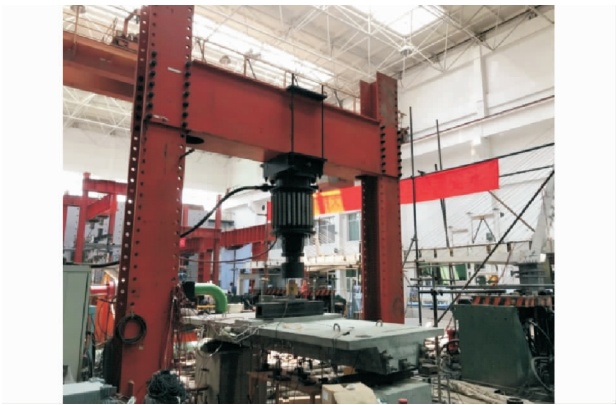
图 2 疲劳试验加载装置 Fig. 2 Fatigue Test Loading Device
