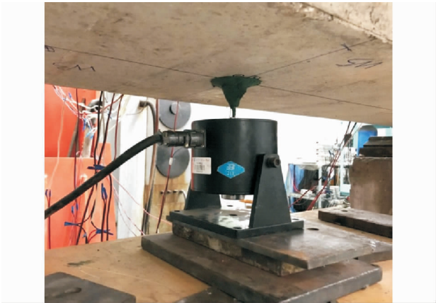
图 3 动测试验加载装置 Fig. 3 Dynamic Test Loading Device
