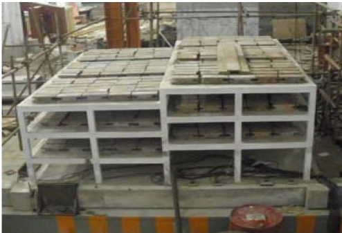
图2 振动台试验模型
