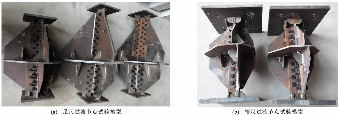
图1 足尺与缩尺过渡节点试验模型
