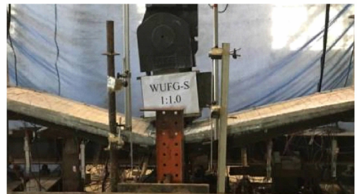
试验 模拟 (b) 无约束侧钢梁腹板完全断裂
