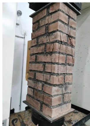
图6 砌体试件的破坏形态
