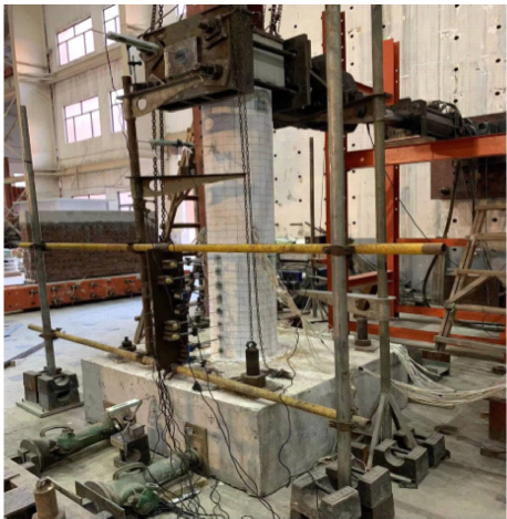
图 3 拟静力试验加载装置
