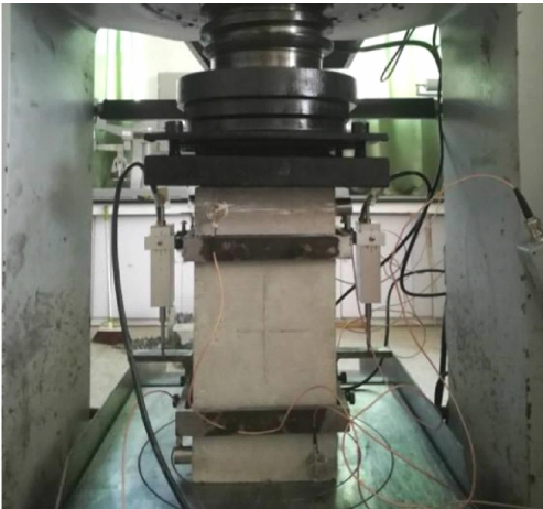
图 1 试验加载装置
