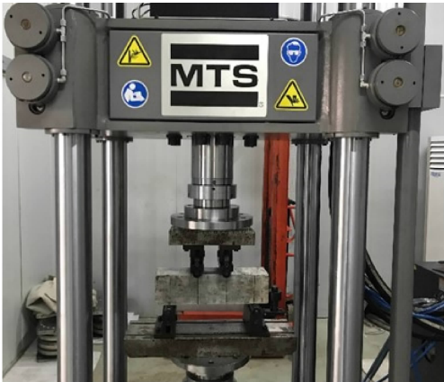
图 1 四点弯曲疲劳试验
