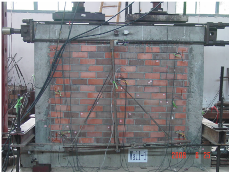
图 7 低周往复水平荷载试验现场 Fig. 7 Low Cyclic Loading Test Site
