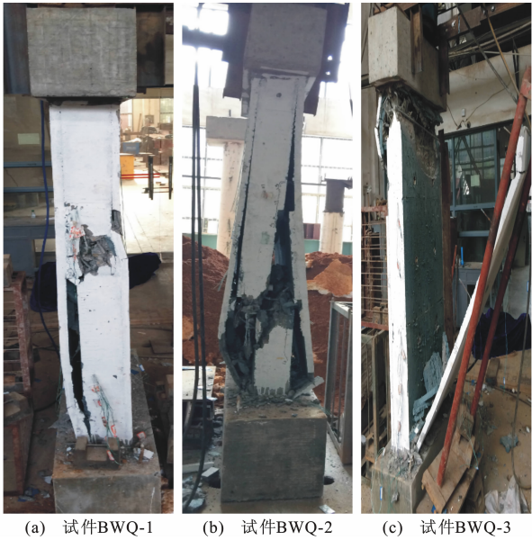
图 8 试件破坏形态
