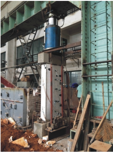
图 5 试验加载装置照片
