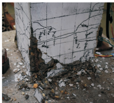
图 5 试件 KKJ 柱脚破坏形态
