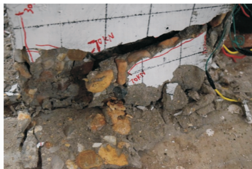
图 6 试件 BKJ 柱脚破坏形态
