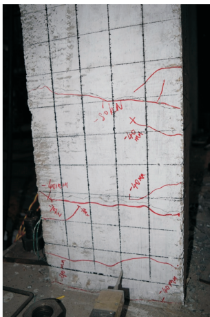
图 7 试件 QKJ 柱脚破坏形态
