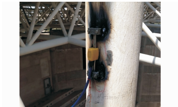
图10 钢弦应力传感器
