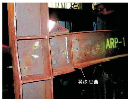
(a) 试件ARP-1试验破坏形态
