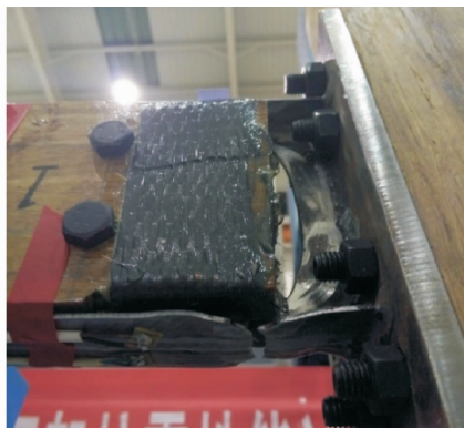
图 11 框架 1 右侧节点最终破坏
