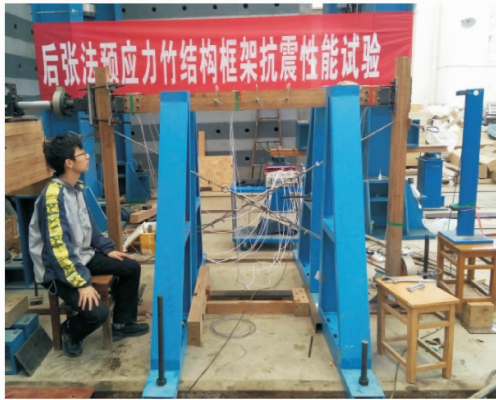
(b) 框架2抗震试验
