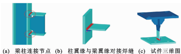
图 2 梁柱连接节点
