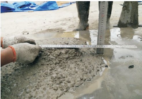
图 1 坍落度试验 Fig. 1 Slump Test
