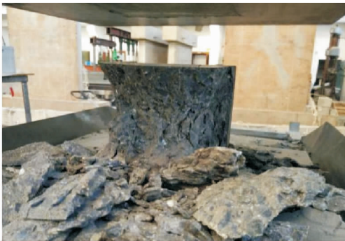
图 2 抗压强度试验 Fig. 2 Compressive Strength Test
