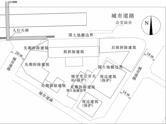
图 1 拟拆除建筑平面图
