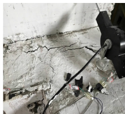
(b) PC2梁翼缘破坏
