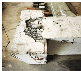
(d) 梁翼缘上部混凝土压碎
