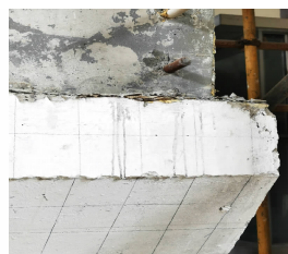
(b) 螺栓断裂
