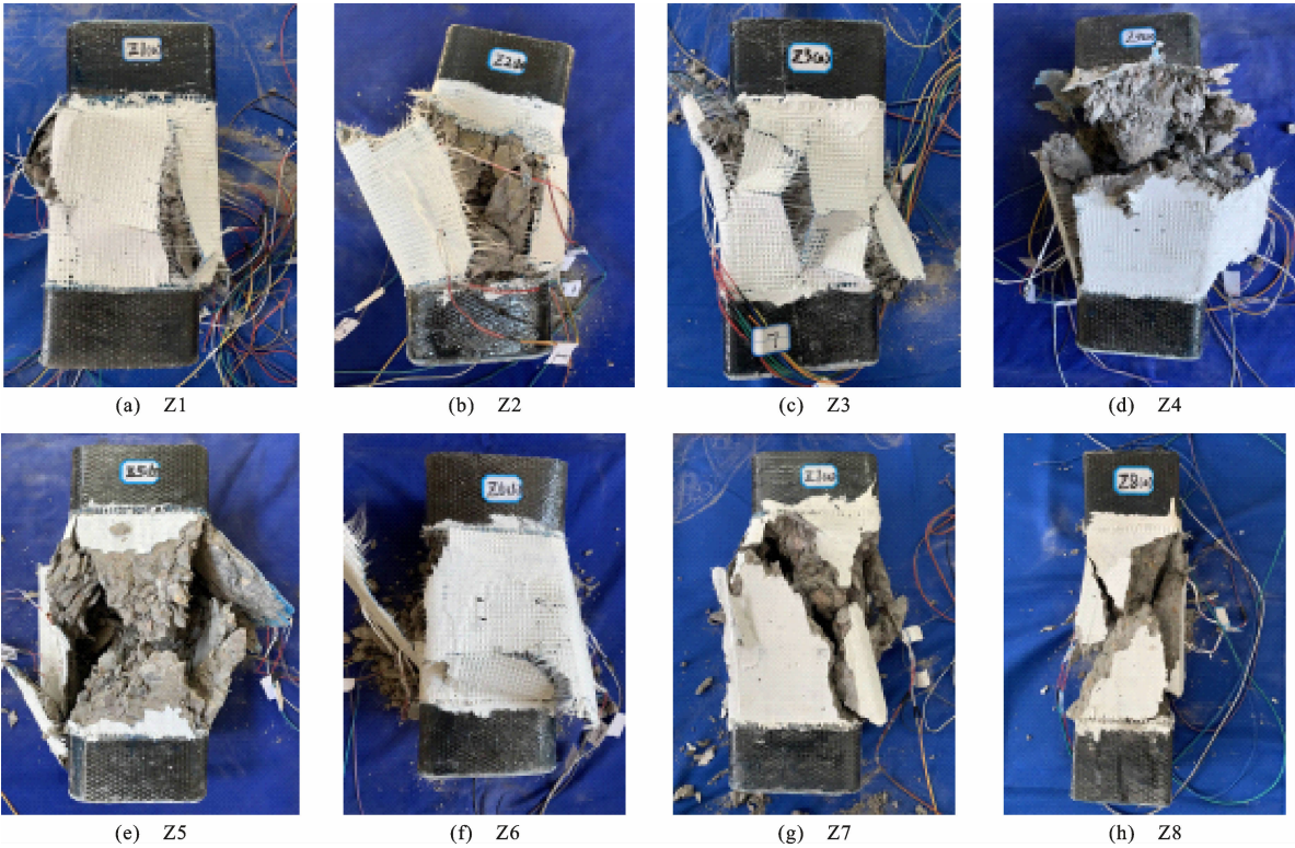
图 5 试件典型破坏形态
