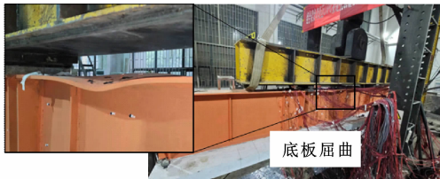
图 8 破坏模式 Fig. 8 Failure mode
