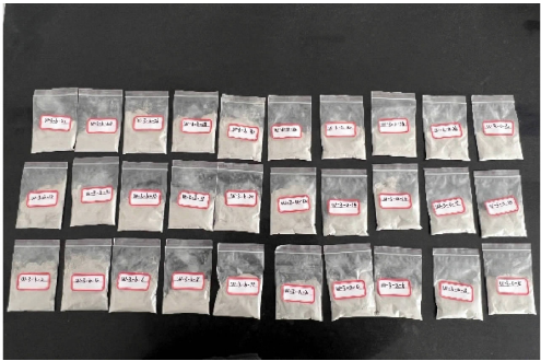
图 2 混凝土芯样取粉
