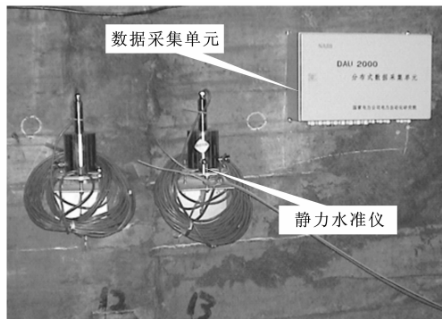
(a) 隧道变形缝处沉降监测
