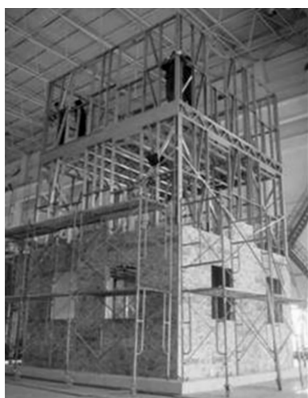
图1 固定在振动台上的模型
