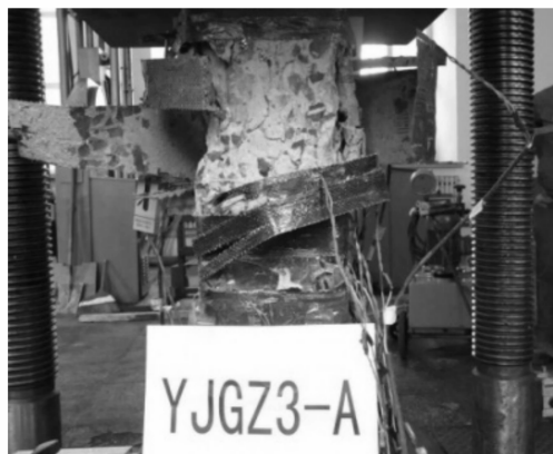
(b) 加固柱预应力CFRP布拉断破坏
