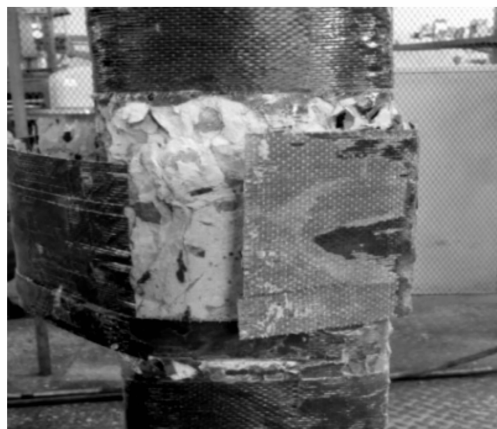
(c) 加固柱预应力CFRP布剥离破坏
