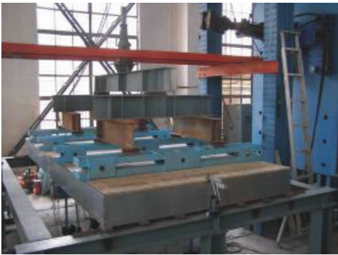
图 2 试验加载装置 Fig. 2 Test Loading Set-up
