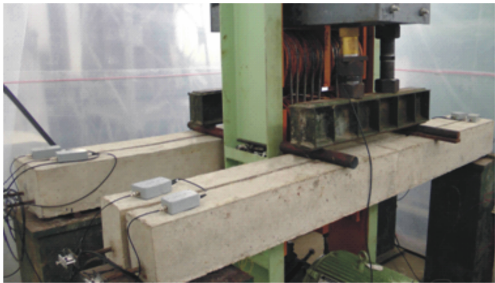
图 2 疲劳加载装置
