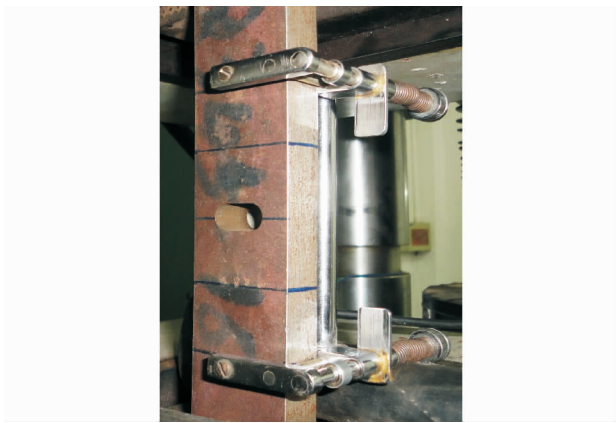
图 4 开孔钢板试件拉伸试验
