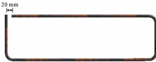
图11 在 Revit 中绘制的有开口箍筋
